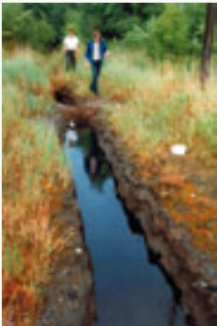
Mitarbeiter des Umweltbundesamtes untersuchen das Gelände eines WGT-Standortes. Der Wasserzulauf im Vordergrund ist durch Treibstoffe und Schmieröle schwer kontaminiert. Ein Test an der Wasserpumpe zeigt: die Flüssigkeit brennt sogar.
