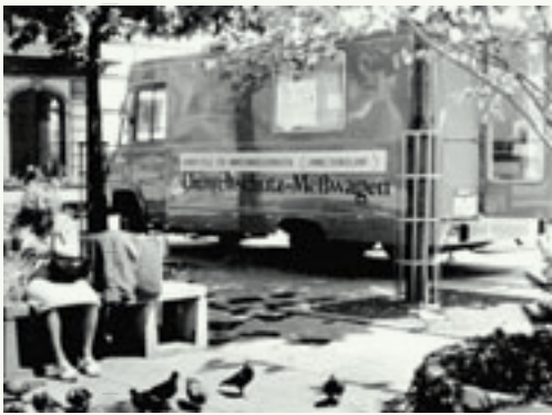
Luftmesswagen der Pilotstation Frankfurt in der Frankfurter Fußgängerzone am 1. Dezember 1973. Die Auswirkungen des autofreien Sonntags am Folgetag wurden mit Vorher-Nachher-Messungen untersucht.
